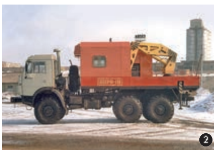
«Нефтемаш». Завод продукциясы: 1. УПР-32 Т күтүрү жайланмасы; 2. АНРВ-1К скважиналары жир өстөндө ремонтлау агрегаты.
