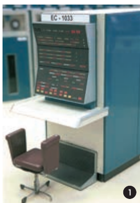
КПО ВС. 1. ЕС-1033 «1-рәт» универсаль электрон цифрлы хисаплау машинасы процессоры стойкасы; 2. ЕС-1045 «2-рәт» универсаль электрон цифрлы хисаплау машинасы.
