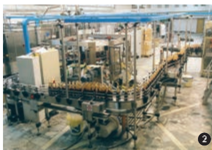
Казан ликёр-аракы заводы мәкаләсенә. 1. Аракы һәм ликёр-аракы эшләнмәләрен шешәләргә тутыру һәм товар рәвешенә китерү линиясе; 2. Йөзем шәрәбларын һәм жиңелчә исерткеч эчемлекләрен шешәләргә тутыручы автомат линия; 3. Завод продукциясе үрнәкләре.
