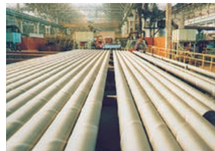
Әлмәт торбалар заводы продукциясе. Спираль жөйле торбалар.
