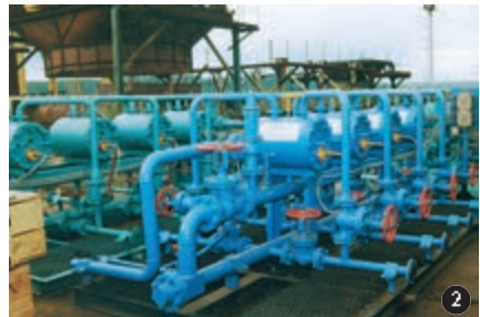
Бөгелмә механика з-ды продукциясе. 1. Каплавчы-торбалы жылылык алмаштыргычлар; 2. Төркемләнү үлчәү жайланмасы.
