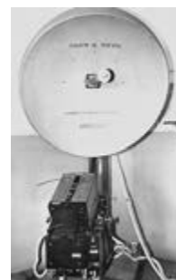
Сантиметрлы диапазондагы дулкыннарның бер көзгеле антеннасы.
