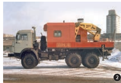
«Нефтемаш». Продукция завода: 1. Подъёмная установка УПР-32Т; 2. Агрегат для наземного ремонта скважин АНРВ-1К.
