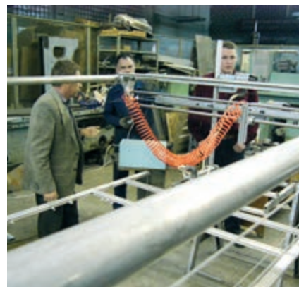
Установка для формообразования заполнителя фюзеляжа.
