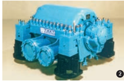
Компрессоростроение. 1. Компрессорный агрегат холодильной установки 10ТХМВ-2000-2; 2. Корпус компрессорной установки ЗЦКК-100/3,5М для кислорода; 3. МЦК 43ВЦ-160/9 общего назначения.
