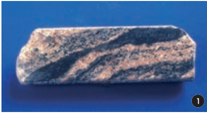
Кристаллический фундамент. 1. Гнейс с гранатом из кристаллического фундамента с глубины более 2 тыс. м. Татарстан; 2. Кристаллический сланец из кристаллического фундамента с глубины более 5 тыс. м. Татарстан; 3. Бiotит-гранатовый гнейс с пирропином из кристаллического фундамента с глубины более 3 тыс. м. Татарстан.
