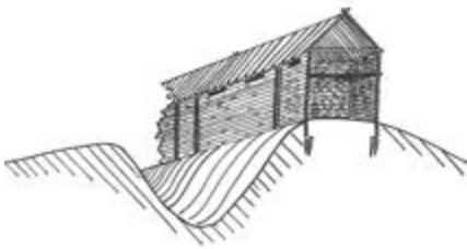
Крепостная стена в виде «городней». Волжская Булгария. 12–13 вв. Реконструкция А.М. Губайдуллина, И.Л. Измайлова.
