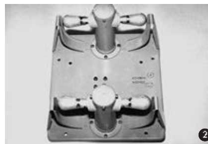
Антенные системы: 1) из шелковых решёток и рупоров; 2) из широкополосных вибраторов.
