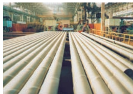
Продукция Альметьевского трубного з-да. Спирально-шовные трубы.
