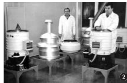
1. Вакуумная металлизационная установка УВН-4М; 2. Сборка диффузионных насосов серии DFR.
