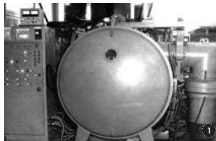
1. Вакуумная металлизационная установка УВН-4М; 2. Сборка диффузионных насосов серии DFR.
