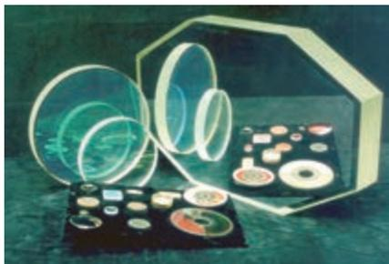
Образцы интерференционных фильтров, зеркал, светоделителей и просветляющих покрытий.
